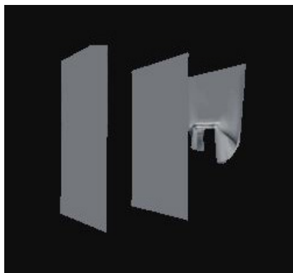
Fig 16. Image du schéma d'ouverture des tulle. Illustration de la première tulle de la séquence en s'ouvrant.
